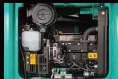
发动机维修保养 宽幅发动机机盖，可轻松接触到发动机部件。
